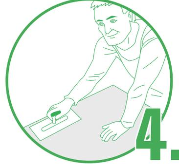
**4.** CaSi-Systems Wohnklimaplatten-Kleber 3in1 im angegebenen Mischungsverhältnis anrühren und mit einem Zahnspatel vollflächig auf die Wand auftragen. Bei ebenen Untergründen kann der CaSi-Systems Wohnklimaplatten-Kleber 3in1 direkt auf die zu verarbeitenden Wohnklimaplatten aufgetragen werden.
