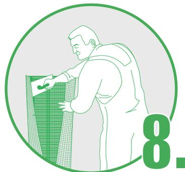
**8.** CaSi-Systems Armierungsgewebe im oberen Drittel der Armierungsschicht einbetten.
