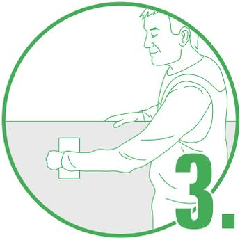
**3.** Auftragen der CaSi-Systems Silikatgrundierung, z.B. mit einem Quast oder einer Druckspritze, auf die CaSi-Systems Wohnklimaplatte Vor- und Rückseite. Vor dem Verkleben: Grundierung der Rückseite. Vor dem Verputzen: Grundierung der Vorderseite.
