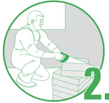
**2.** Zur Vorbereitung wird an der Decke als auch am Boden ein Trennstreifen zur mechanischen Entkopplung angebracht. Der Zuschnitt der CaSi-Wohnklimaplatte erfolgt mit einer Fuchsschwanzsäge.
