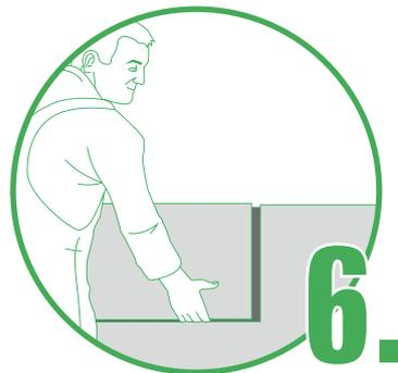
**6.** ...mit gleichmäßigem Druck an den Untergrund andrücken und einschwimmen. Die Platten werden stumpf und ohne Kleber in die Stoß- und Lagerfugen gestoßen.
