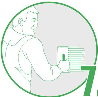
**7.** Aufbringen des CaSi-Systems 3in1 Wohnklimaplattenkleber als Armierungsschicht mit der Zahnkelle. Eventuell vorhandene Plattenversätze müssen vorab verschliffen werden und nach Entfernen des Schleifstaubes, zur Reduzierung der Saugfähigkeit, einmal mit der CaSi-Systems Silikatgrundierung vorbehandelt werden.
