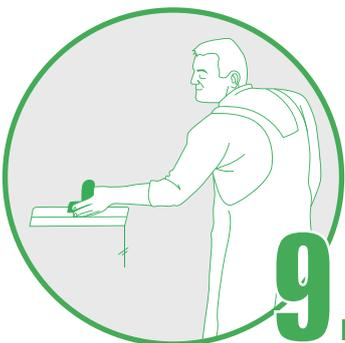
**9.** Anschließend die gesamte Fläche abspachteln und glätten. Nach der Trocknungszeit können Sie mit der diffusionsoffenen Oberflächengestaltung, z.B. mit einer Silikatfarbenfarbe, beginnen.
