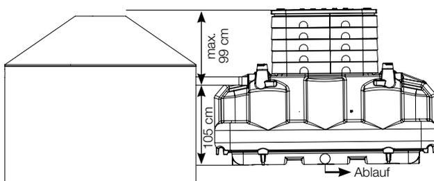
Beispiel: Filtertank (flacher Einbau) mit Zulauf über zwischengeschalteten Hebeschacht
