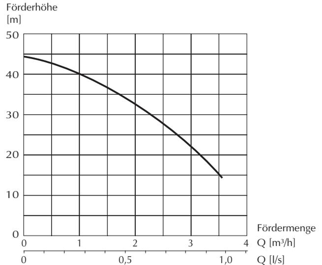
Bild 5 Pumpenkennlinie:
