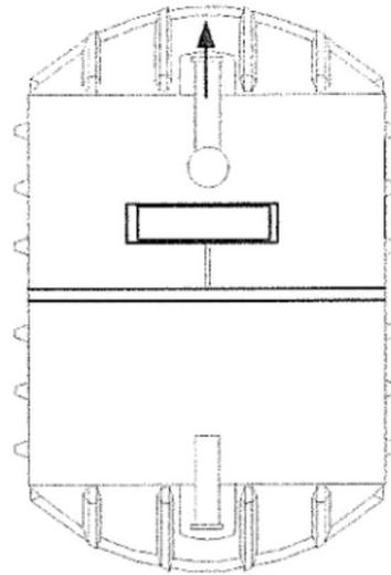
Herstellung: Rotationsintervallverfahren; Werkstoff: PE
