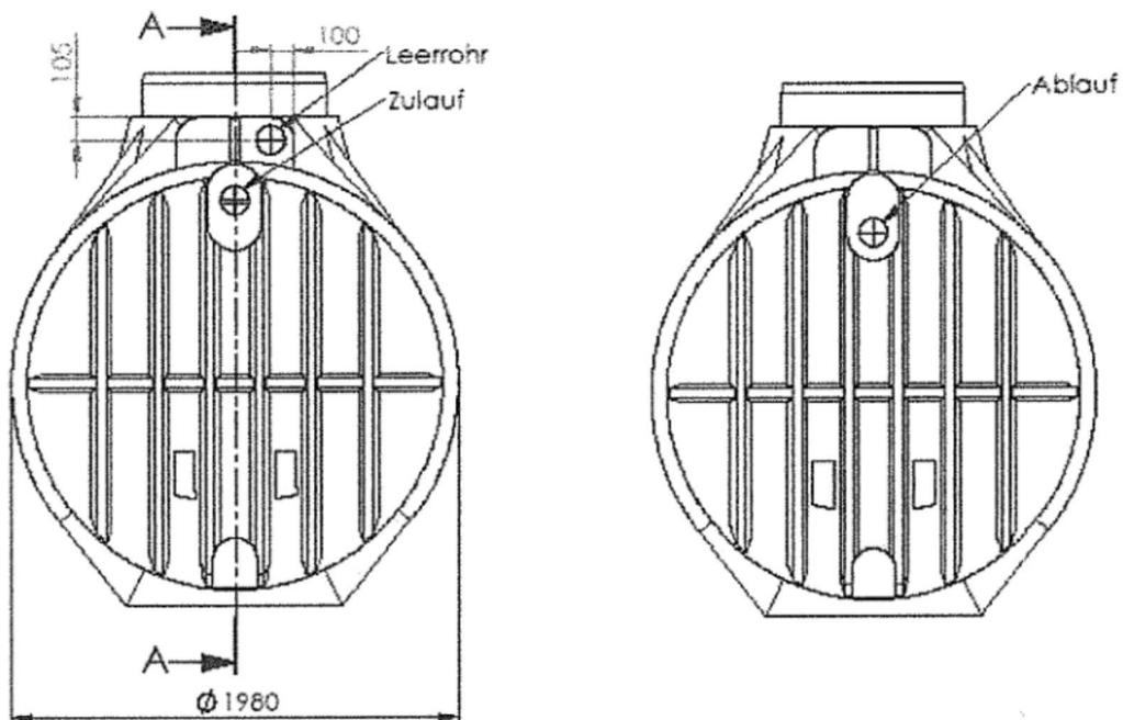
Anwendungsbestimmungen für Kleinkläranlagen nach DIN EN 12566-3 mit CE-Kennzeichnung: SBR-Anlagen Typ Solid Clair Quick aus PE für 4-50 EW, Ablaufklasse D
