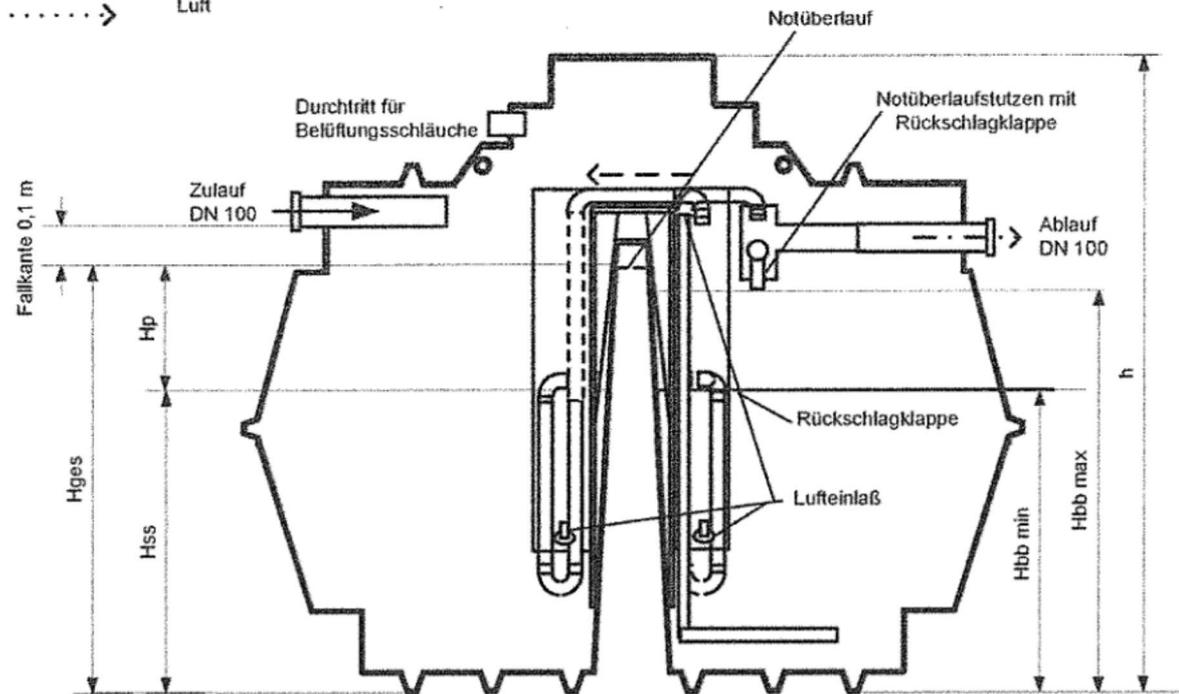
Herstellung: Rotationsintervverfahren; Werkstoff: PE
