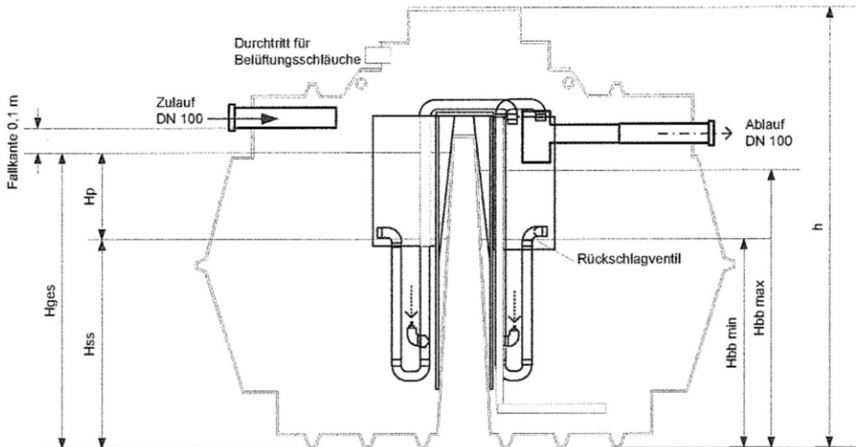
Herstellung: Rotationssinterverfahren; Werkstoff: PE
