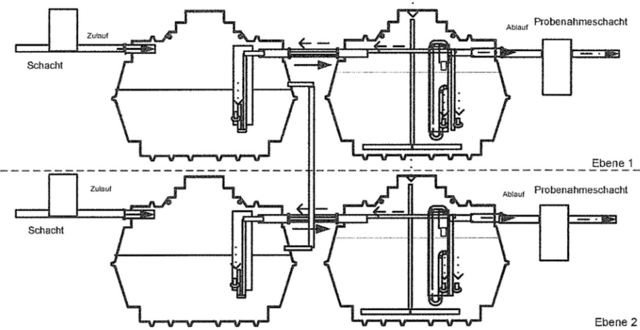
Herstellung: Rotationssinterverfahren; Werkstoff: PE
