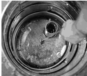
5. Den Haken des Werkzeugs in die mittlere Öse des Filters einhaken.
