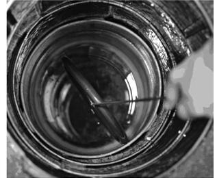
3. Gummidichtung mit dem Werkzeug herausholen.
