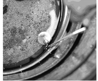
3. Eine Auftriebssicherung mit dem Werkzeug nach innen drehen.
