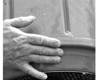
6. Mit der Hand kontrollieren, dass keine Verunreinigungen auf der Kante zurückbleiben.
