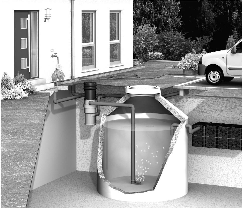
Die Anlage Typ metal hat eine bauaufsichtliche Zulassung gemäß Art. 41f des Bayerischen Landeswassergesetzes bekommen (LfU BY-41f-2010/2.1.0). Damit ist belegt, dass sie mehr als 90 % Zink und 98 % Kupfer aus dem Regenabfluss von Metalldächern über das Jahresmittel entfernt. Sie darf daher in Bayern erlaubnisfrei für die Versickerung von Metalldachabflüssen verwendet werden. Eine Zulassung für die Ableitung in Oberflächengewässer ist in Vorbereitung.
