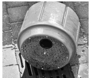
3. Die Unterseite des Filterelements muss komplett sauber sein.
