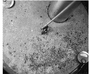
6. Den Filter aus dem Schacht heben und abtropfen lassen.
