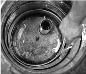
4. Die zweite Auftriebssicherung nach innen drehen.
