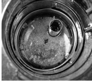
2. Blick auf den Filter, die Auftriebssicherungen sind festgestellt und die Überlaufklappe ist fest montiert.
