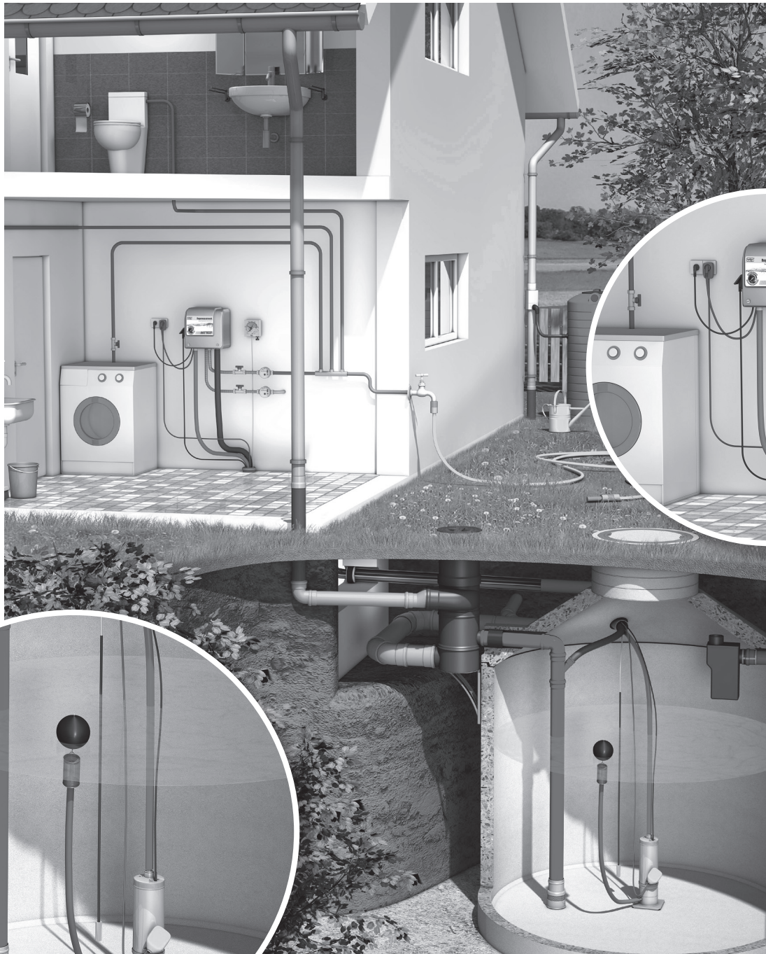
Regenwasseranlage mit Multimat und Regenspeicher mit Wirbel-Fein-Filter
