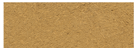
Lehmunterputz, erdfeucht mit Flachsfasern, gerieben
