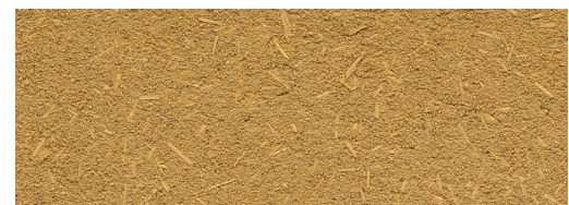
Lehmunterputz, trocken, gerieben
