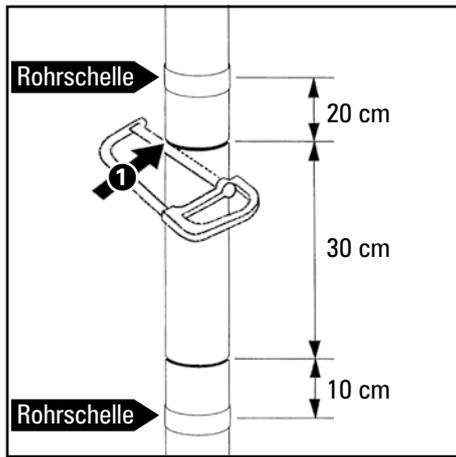
**1** Das Regenfallrohr in der gewünschten Einbauhöhe an 2 Stellen durchsägen. Der Sägausschnitt sollte für alle Typen unserer Filtersammler 30 cm betragen. Die abgeschnittenen Rohrenden mit einer Halbrundfeile sauber entgraten.
