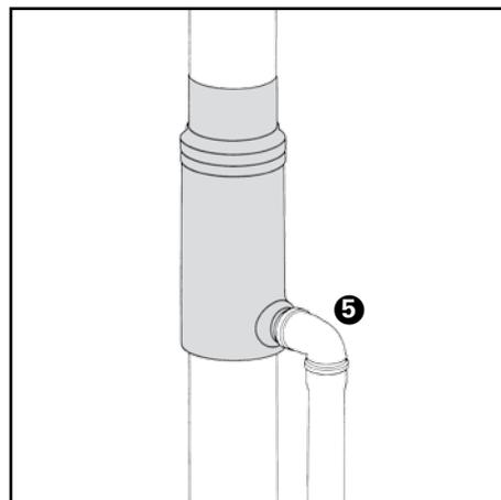
**5** Auslaufstutzen mit 50er Rohren (HT, PE) und den zugehörigen Gummidichtungen anschließen. Um einen schnellen Ablauf des Wassers aus dem Stauraum zu ermöglichen, empfehlen wir, diesen Anschluß mit einem Rohrbogen (nach unten abgehend) vorzunehmen.
