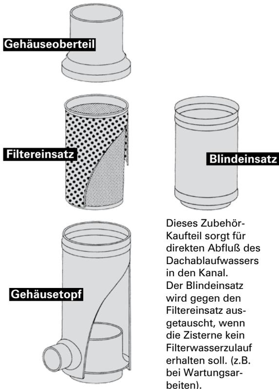
Dieses Zubehör-Kaufteil sorgt für direkten Abfluß des Dachablaufwassers in den Kanal. Der Blindeinsatz wird gegen den Filtereinsatz ausgetauscht, wenn die Zisterne kein Filterwasserzulauf erhalten soll. (z.B. bei Wartungsarbeiten).
