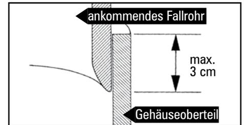
● Bei richtiger Montage sollte das obere Regenfallrohr höchstens 3 cm in das Gehäuseoberteil hineinragen.
