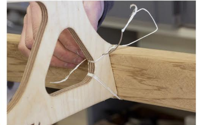
4 - so wird die Sehne (außer an Spant 5) gelegt
