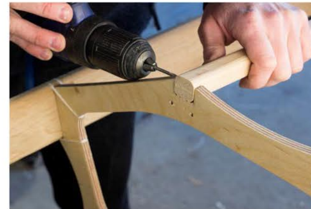
1 - Loch bohren (bei Spant 4)
