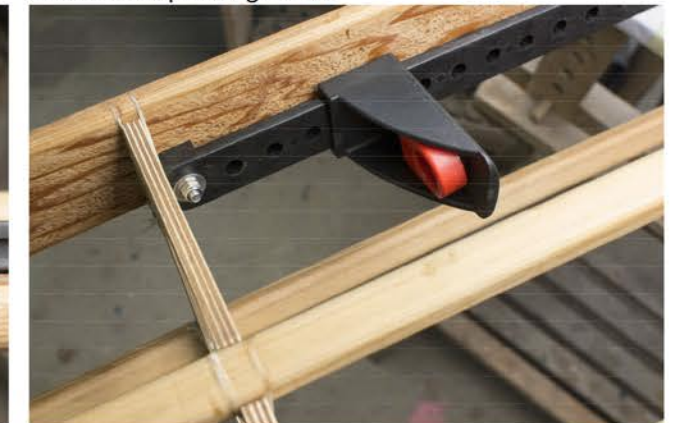
5 - Befestigung bei Spant 3
