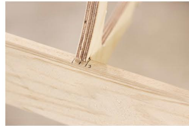
1 - Platzierung der Spanten zwischen den Markierungen
