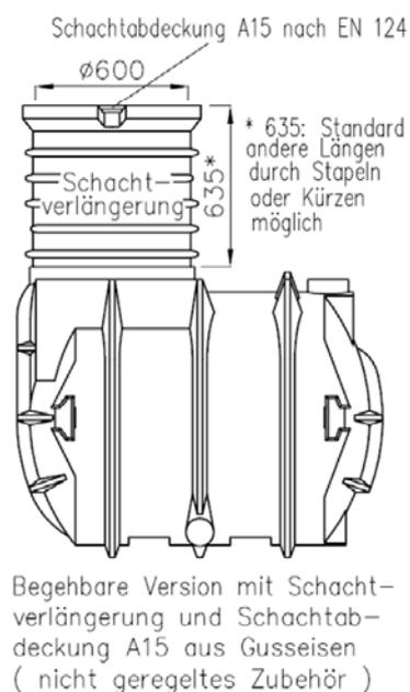
Abflusslose Sammelgruben aus rotationsgeformten Polyethylen (PE-LLD)
