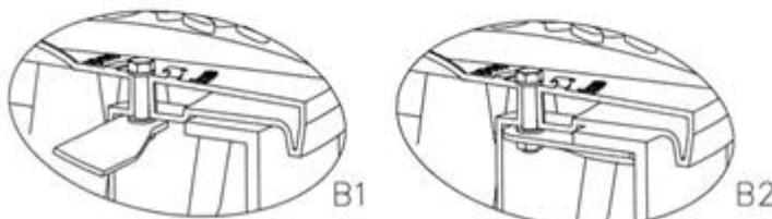
B1 Sicherungsriegel geöffnet
