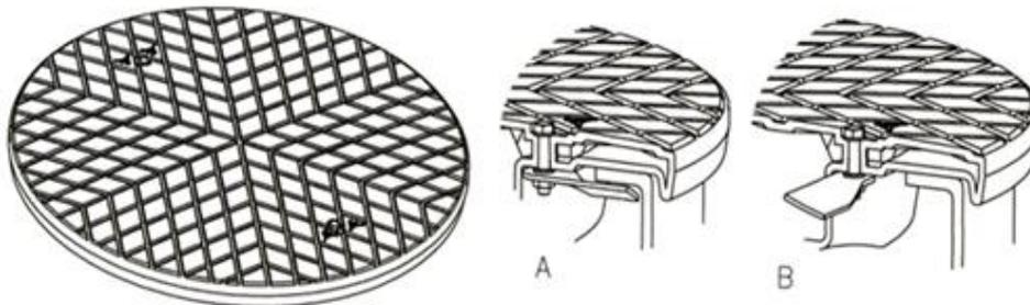
A Sicherungsriegel geschlossen
