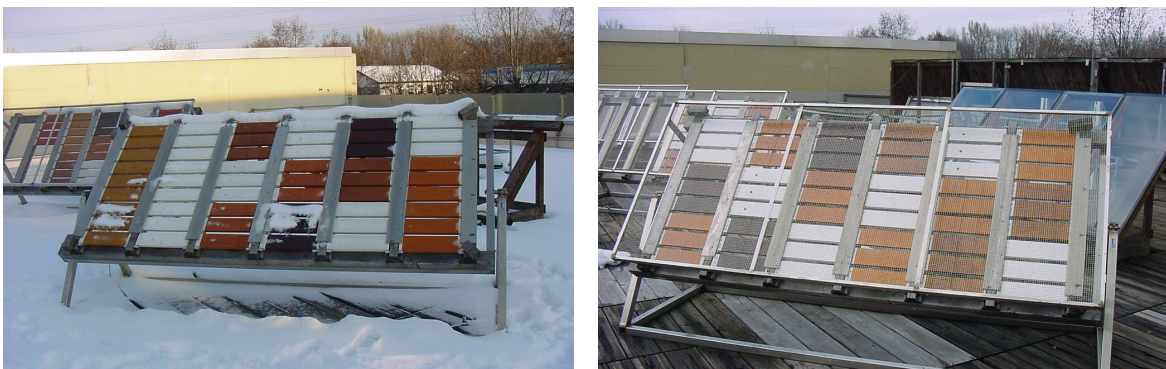
Bild 1 Prüfstand im Winter und im Sommer (mit Hagelschutzgitter)
