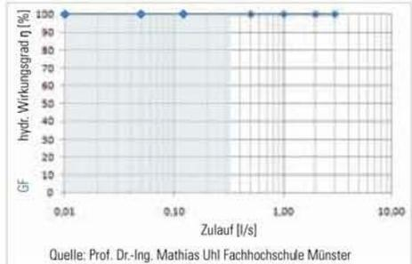
Durchschnittliche Regenspende in Deutschland zu 80% unter 15 l/(sxha), das ergibt einen Volumenstrom von 0,32 l/s bei einer Dachfläche von 213 m<sup>2</sup>.
