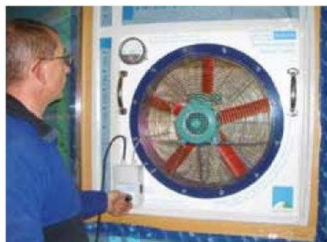
Sind alle Anschlüsse luftdicht hergestellt, ist die Wärmedämmkonstruktion dauerhaft sicher. Empfehlenswert ist die Überprüfung der Luftdichtheit mit einer BLOWER DOOR oder einem pro clima WINCON.
